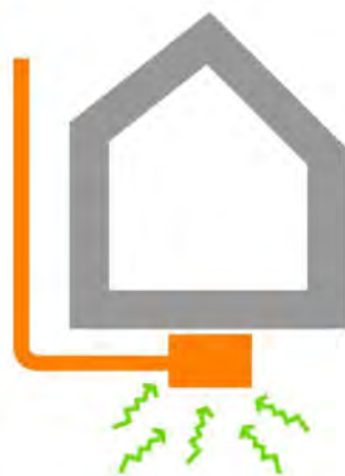
Figura 13: depressione del sottosuolo tramite pozzetto.
